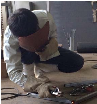
ガス・アーク溶接
